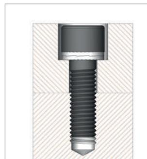
Tornillo cilíndrico asegurado en un agujero ciego
